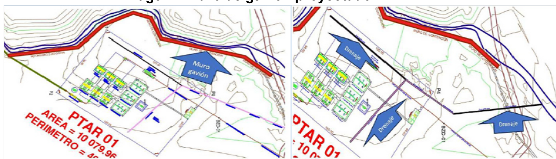
Imagen1. Muro de gavión proyectado – PTAR 1
